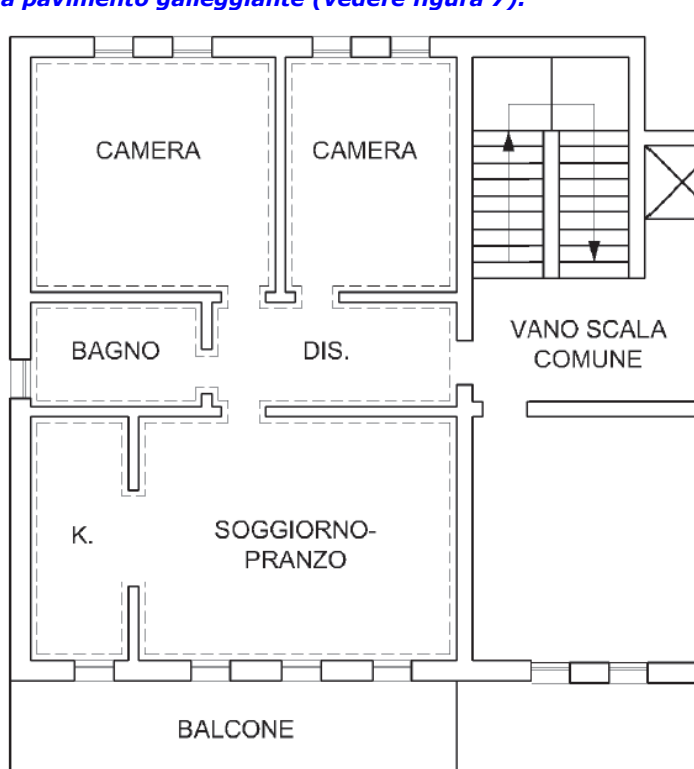
Figura 7 — Esempio di posa della banda di isolamento perimetrale in un appartamento residenziale
