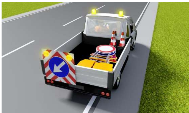
Figura 5 – Allestimento mezzo posa segnaletica
