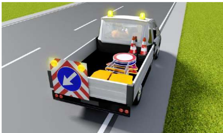
Figura 1 – Allestimento mezzo posa segnaletica
